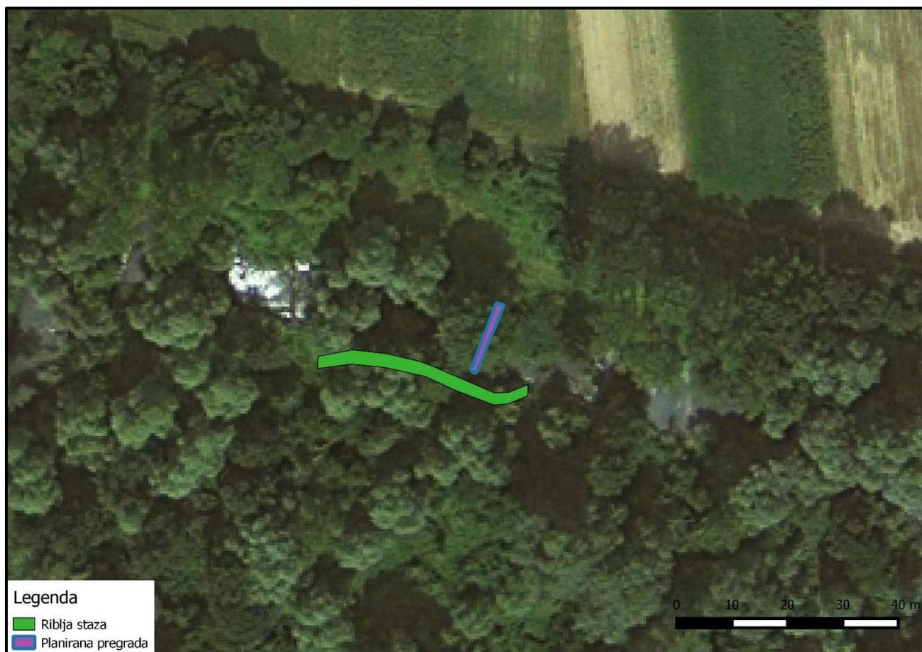
Slika 2.5 Prikaz kanala za preusmjeravanje i planirane riblje staze uz planiranu pregradu (Izrađivač: IRES EKOLOGIJA d.o.o.)
